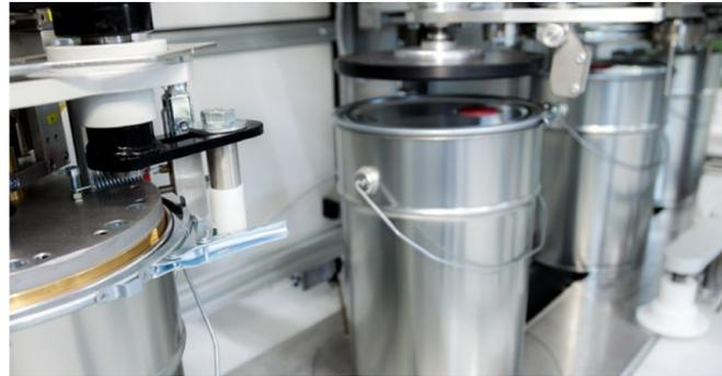
FlexoClose ist die neue Generation von Verschließmaschinen für mittlere und große Industrieverpackungen aus Weißblech (5,0 – 33,0 Liter) mit Spannringverschluss. Mit nur einer Anlage verschließen Sie bis zu vier Gebindedurchmesser, dies wird ermöglicht durch ein modular aufgebautes, variables System.
